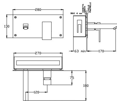
LE VITI PER IL FISSAGGIO DELLA PIASTRA, SPORGONO DALLA STESSA VERSO LA CASSETTA PER 11 mm. ESEGUIRE LA MURATURA DELLA CASSETTA SECONDO LE INDICAZIONI FORNITE.
